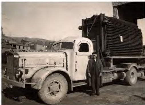
Zona de la central, tanque transformador de 2.500 KVA 110/25 KV de 7 toneladas.
