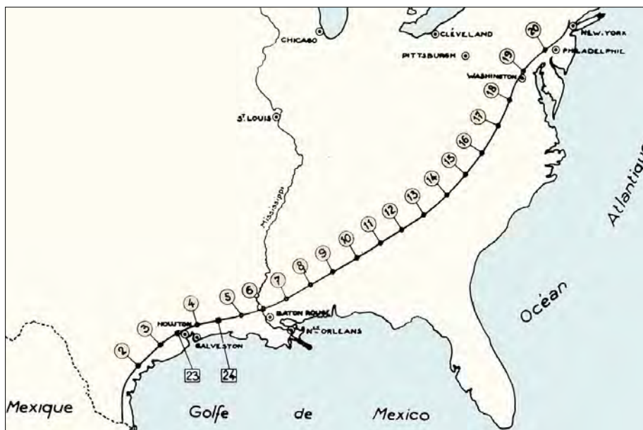
Gasoducto entre Texas y Nueva York de la Transcontinental Gas Pipe Co. Puesto en servicio en 1951 con 3.975 km y tubería de acero de 30" (760 mm) de diámetro a 60 kg/cm 2 de presión. En el trayecto necesitaba 24 estaciones de compresión para mantener la presión. ( Gaz d'Aujourd'hui , 1970: 175) (SEDIGAS, 2005:22).
