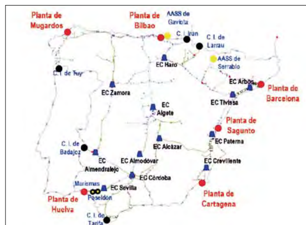
Estructura del sistema gasista español. Yacimientos en Marismas y Poseidón. Plantas de recepción de GNL, Almacén subterráneos (AASS), Centros internacionales de control y medida del gas (CI), Estaciones de compresión (EC). Fuente: Gas Actual, nov 2008, nº109: 24.
