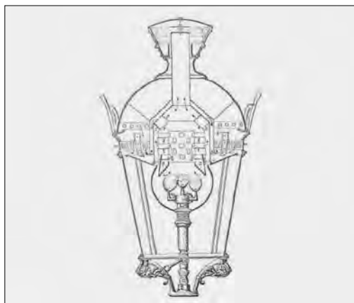
Mechero de recuperación el Industrial (Marechal, 1894: 111).
