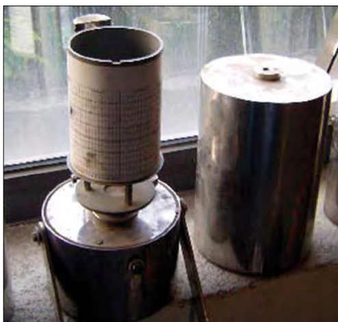
Aparato medidor de presión en la red de gas. El aparato se conectaba a la tubería en el punto de la red que se había seleccionado y la medición se efectuaba mediante un marcador situado en la parte opuesta de la imagen. Mediante un mecanismo de relojería el cilindro giraba durante un intervalo de tiempo, usualmente 24 horas, y el marcador iba dejando registrada la presión en la hoja de papel circular. El conjunto quedaba cerrado por la tapa de la derecha para evitar mediciones incorrectas (AHFGNF).
