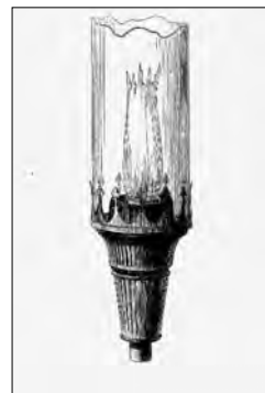
Mechero Dumas con su chimenea (Figuier, 1873: 160).
