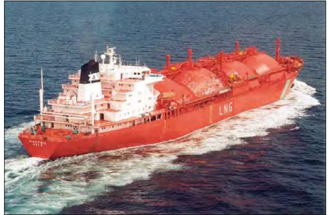
Buque metanero “Venator” el primero construido en 1973 con la técnica Moss-Rosenberg (Cortesía y copyright de Moss Maritime, Noruega ).
