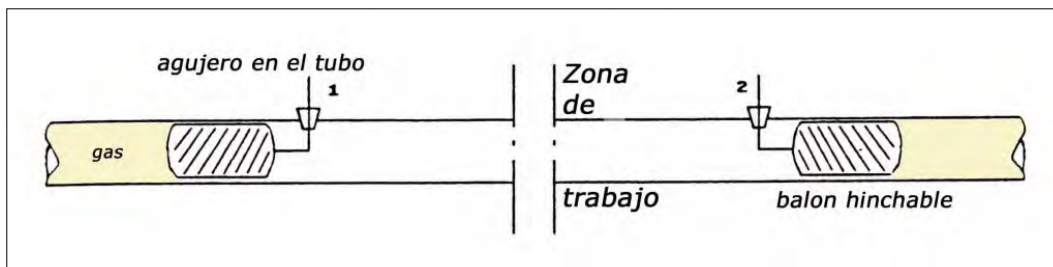
Sistema de obturación de tubos de gas de baja presión mediante balones hinchables que impiden el paso del gas y permiten efectuar trabajos de conexión o de sustitución.
