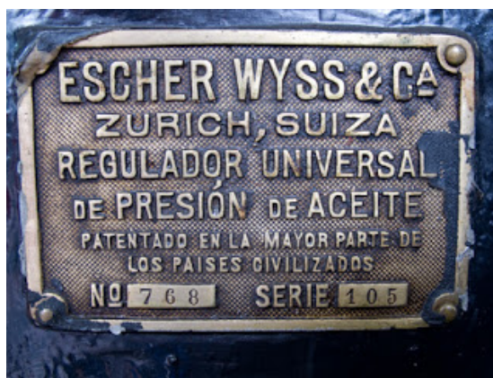
Placa de características instalada en un regulador de turbina Escher Wyss "patentado en la mayor parte de los países civilizados". Central de Seira.
